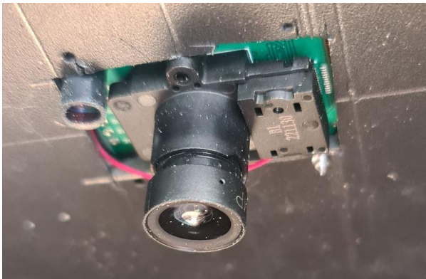
Abbildung 5 Die IMX290 Kamera an der Unterseite des Einschubs
